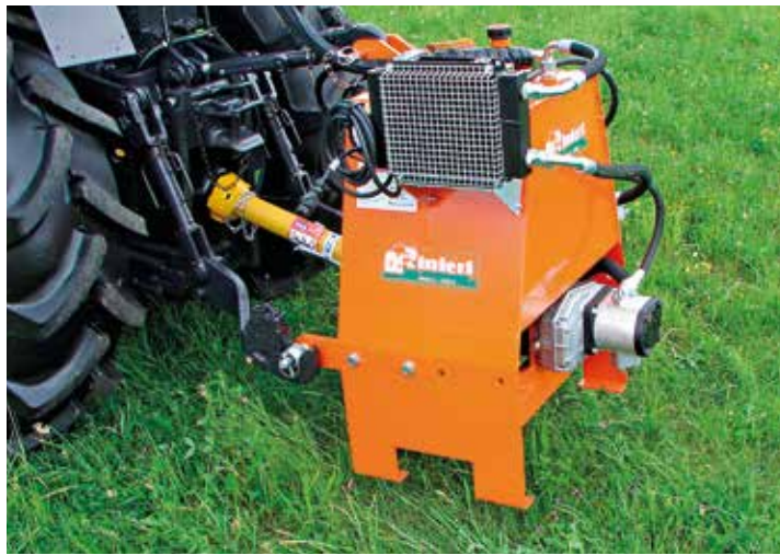
Fot. 2. Niezależny układ hydrauliczny maszyn do konturowego cięcia sadów
