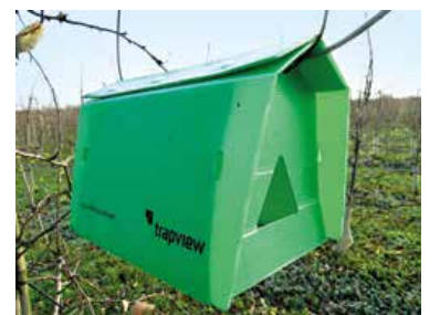
l'Trap pozwala na obserwację lotów w oddalonych sadach
