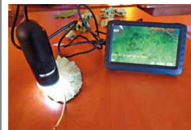
Przenośne urządzenie pozwalające na obserwację liści w 100-krotnym powiększeniu
