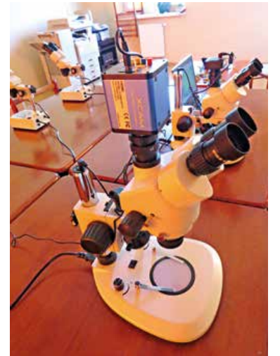
Wysokiej jakości kamera HD zamontowana na binokularze
